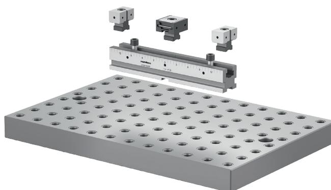
Montaje del sistema de sujeción múltiple adecuado para los sistemas de retícula.
